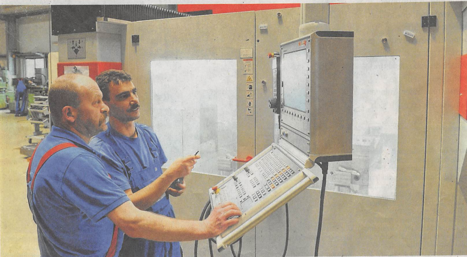
Norbert Lohse (links) und Holm Jähnichen, Mitarbeiter der Oederaner Firma Brand Werkzeug- und Maschinenbau, programmieren die neue hochmoderne CNC-Fräsmaschine. Damit können nun auch große, komplexe Werkzeuge hergestellt werden.
